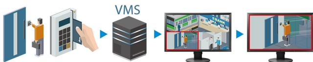
Esempio: la notifica dell'accesso mediante key card viene inviata direttamente al VMS che a sua volta istruisce il monitor DuraVision DX0211-IP di ingrandire la schermata.
