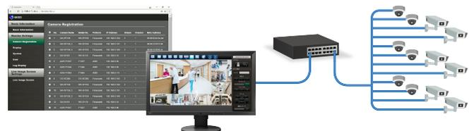
Collegamento fino a 48 telecamere IP a DuraVision DX0211-IP mediante uno switch rete.
